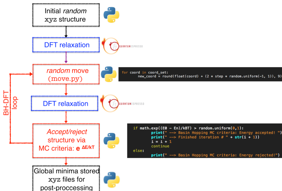
Figura 2. Diagrama de flujo de nuestra implementación de la rutina de optimización global Basin Hopping Monte Carlo (BH-DFT), acoplada al software libre DFT, Quantum Espresso.
